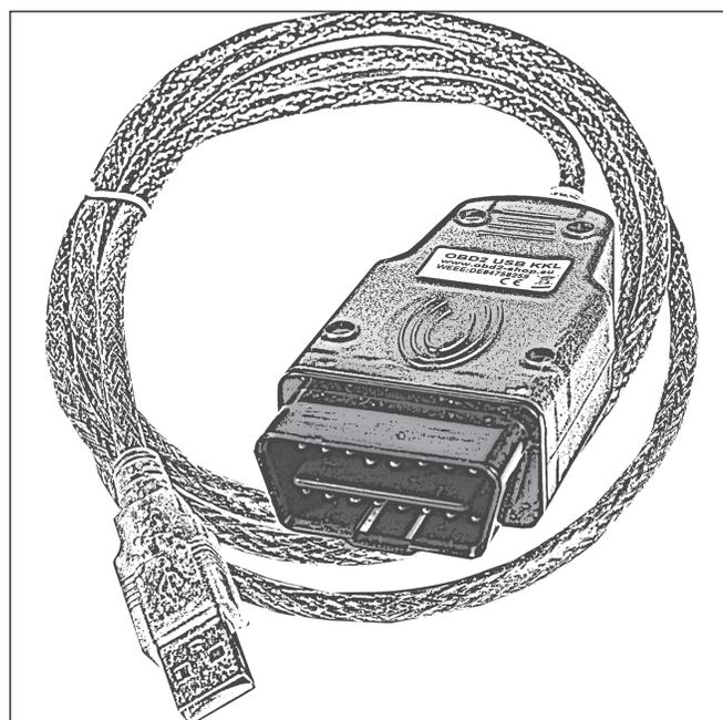
Abbildung 10: Typisches OBD USB KKL Diagnoseinterface [16]
