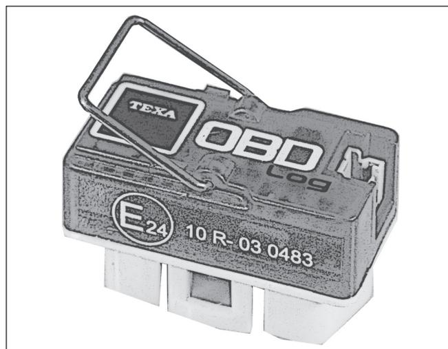
Abbildung 15: Kleiner Daten-Logger mit einer USB-Schnittstelle [26]
