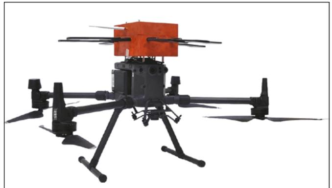
Abbildung 1: In-Flight-QoS-Messsystem, montiert auf eine handelsübliche Drohne.
